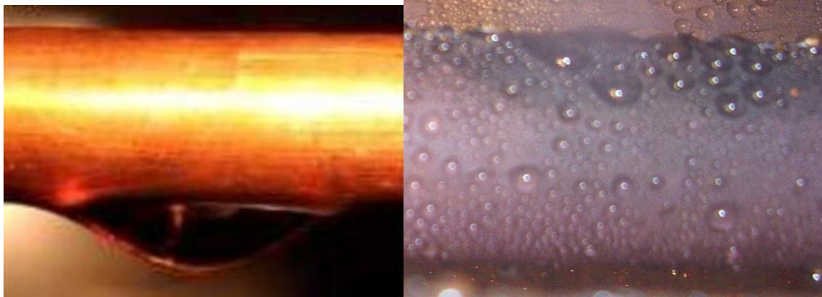
Рис. 6. Зовнішній вигляд процесу конденсації на поверхні горизонтальної труби: а) – плівкова конденсація, б) – псевдо краплинна конденсація.
