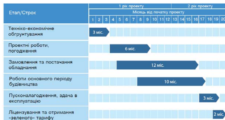
Рис. 3 – Етапи реалізації проекту будівництва теплоелектроцентралі
