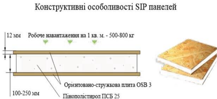
Рисунок 1 – Теплоізоляційна панель SIP
