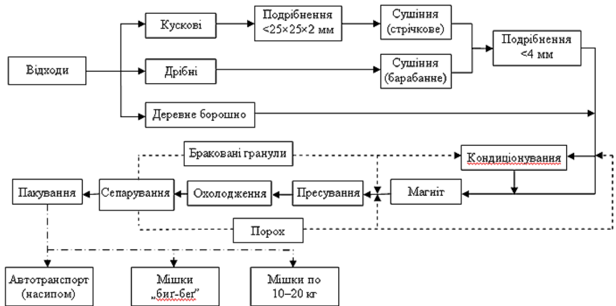
Рис. 1. Технологічна схема виробництва пелетів
