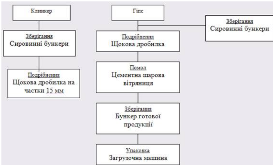
Рис. 1. Технологічна схема виробництва цементу на Подільському цементному заводі
